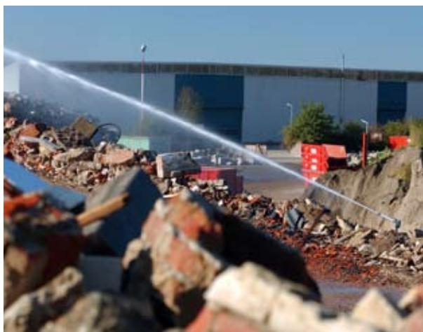
Überall wo mit Schüttgut gearbeitet wird entsteht Staub - zum Beispiel bei Sand, Koks, Kohle, Erze usw. Dieser Staub ist eine Belastung für die Natur und den Menschen. Zum Schutz von Umwelt, Natur und Menschen ist die Staubbindung auf Schüttgut verarbeitenden Anlagen ein Muß geworden.
